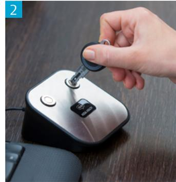
2 Nach dem Sperren wird ein weiterer Schlüssel mit den geänderten Zutrittsberechtigungen programmiert – auf allen Geräten, auf der die CLIQ® Go-App installiert ist, lässt sich dies verfolgen.
