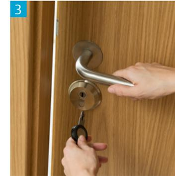
3 Mit Einstecken dieses Schlüssels in den Zylinder einer betreffenden Tür werden die neuen Zutrittsberechtigungen übertragen. Der verlorene Schlüssel kann an diesem Zylinder nicht mehr schließen, alle anderen berechtigten Schlüssel haben weiterhin freien Zutritt.
